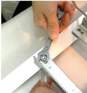
4. フレーム内側のボルトの頭と外側のナットとをスパナで締め付けしっかりと締めます。
