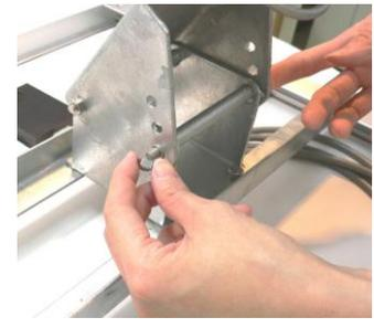
6. 長ボルトのネジ山のある方へワッシャーとナットを嵌め確りと締め付けます。
